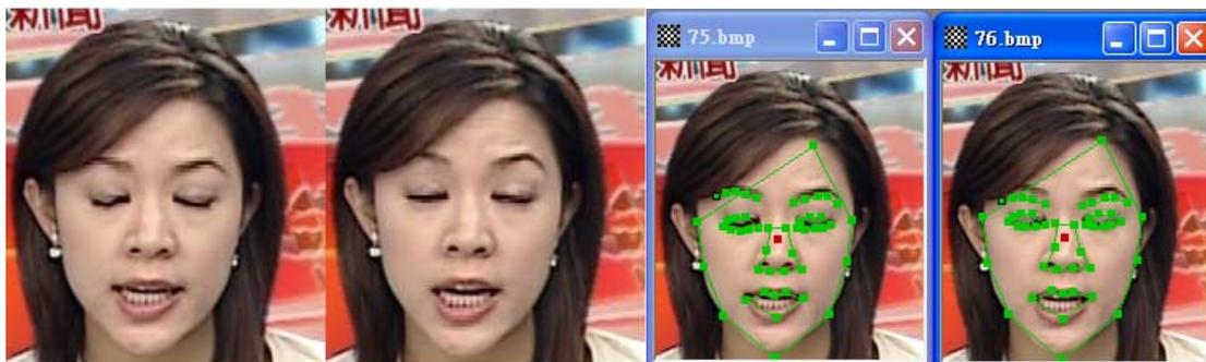
圖十一、連續兩張眉型變化過大，造成 AAM 在眉毛的偵測上產生誤
