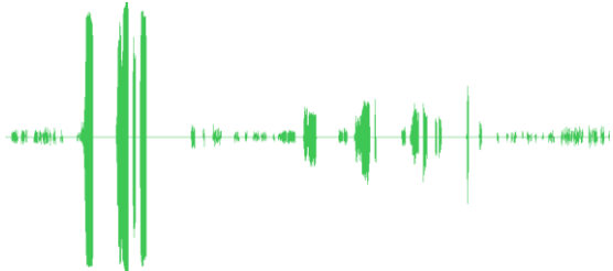
圖 19：含有回音的聲音波形經過 LED VAD 過濾結果
