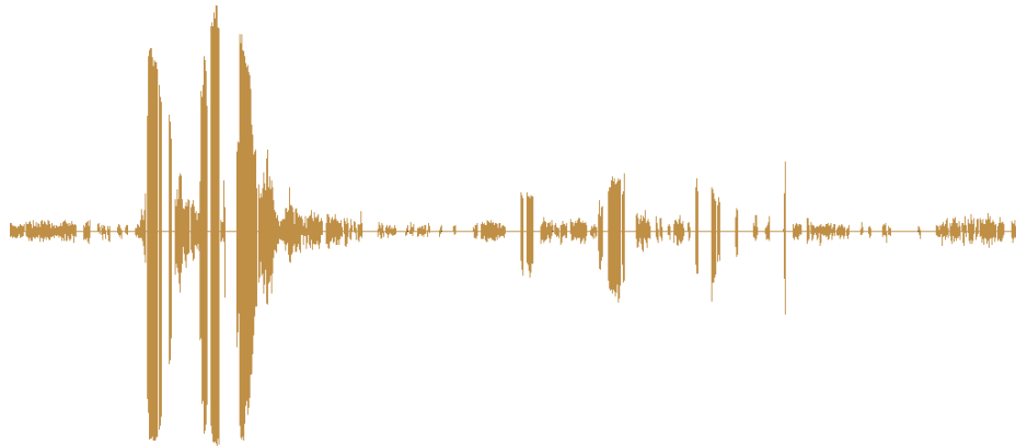
圖 44：含有回音的聲音波形經過 WFD VAD 過濾結果
