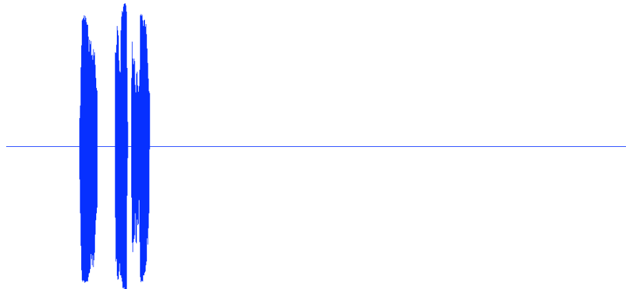
圖 45：含有回音的聲音波形經過 MET VAD 過濾結果
