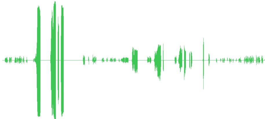
圖 43：含有回音的聲音波形經過 LED VAD 過濾結果
